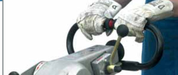
Držadla "mrtvý muž" s elektronickým senzorem (volitelný)
